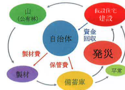
fig.8 発災時には備蓄材ですぐに仮設住宅を建設する
